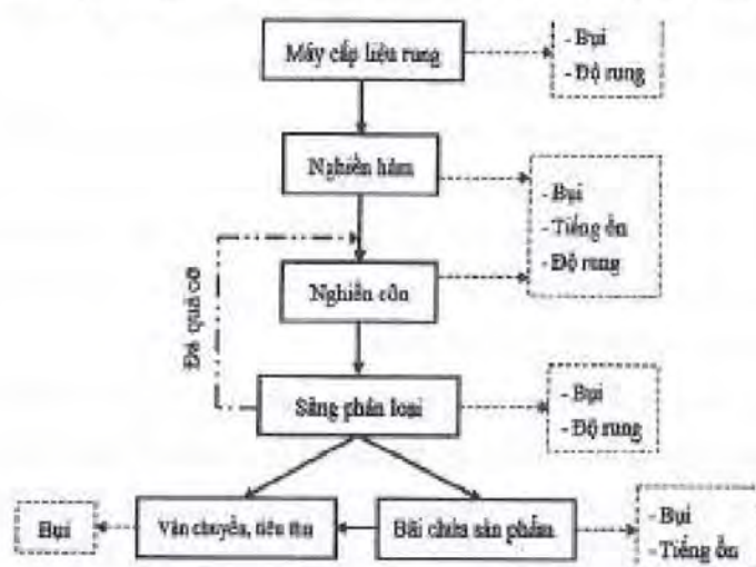
Hình 1.5. Sơ đồ công nghệ chế biến đá và dòng thải phát sinh
