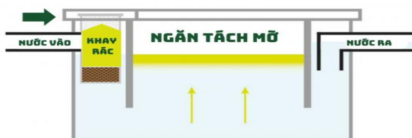
Hình 4.5. Cấu tạo bể tách dầu mỡ
