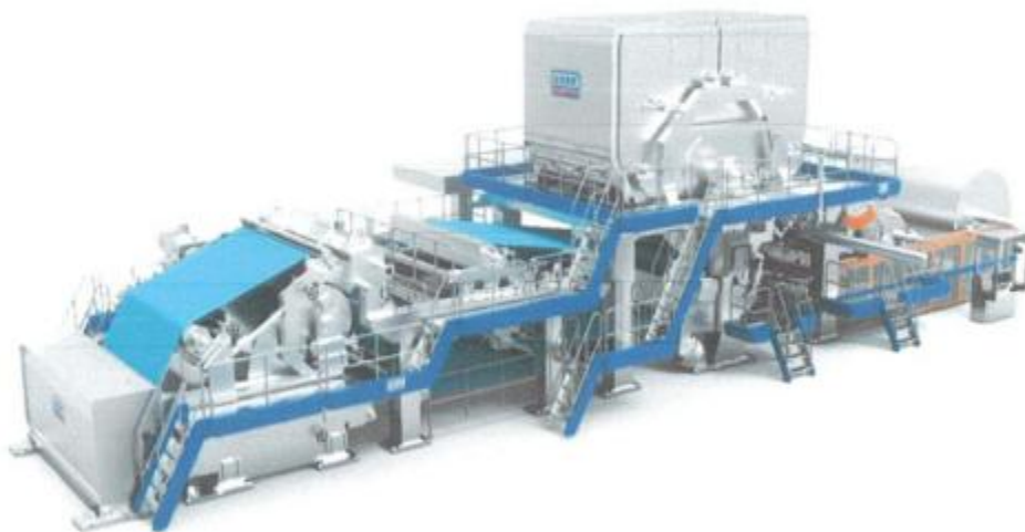
Hình 1.4. Hình ảnh dây chuyền sản xuất giấy tissue quy mô 20.000 tấn/năm
