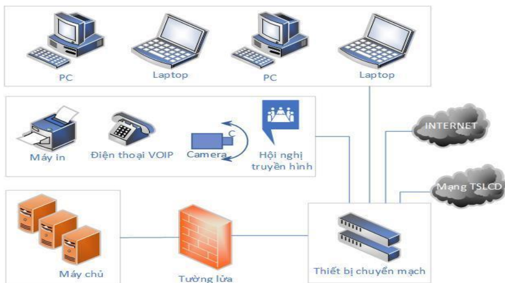
Hình 32: Sơ đồ kết nối mạng có dây
