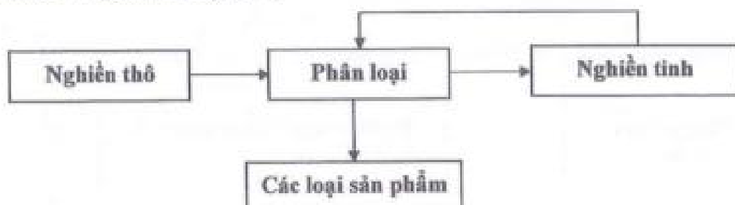
Hình 10.2: Sơ đồ công nghệ nghiền không qua phân loại trung gian
