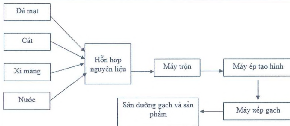
Hình 1.7. Quy trình công nghệ sản xuất gạch không nung
